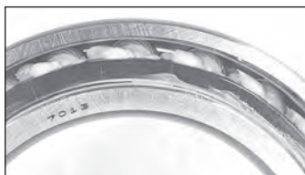
Рис. 1: Радиальный упорный шарикоподшипник в смазке
